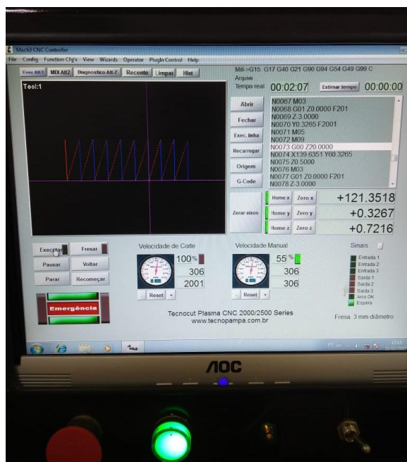
Figura 3 – Interface do programa Mach 3 CNC Controller evidenciando o esquema de corte.
