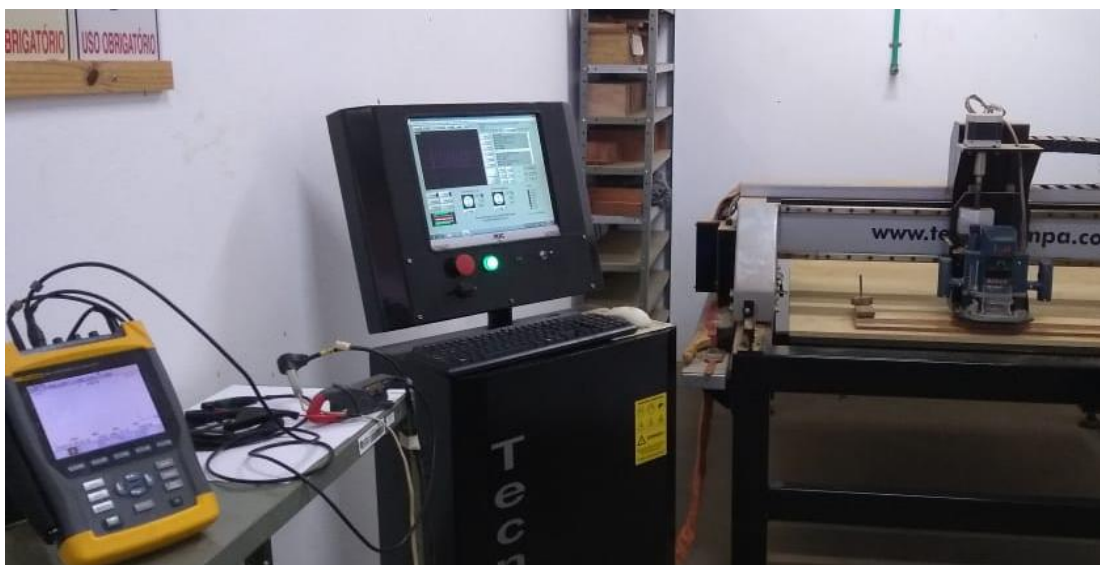
Figura 5 – Setup do sistema de obtenção dos dados de energia de corte em tupia com CNC.
