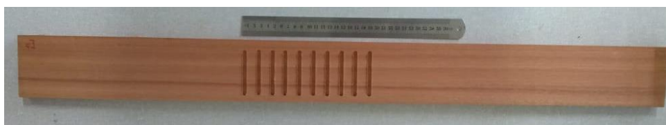
Figura 2 – Esquema dos cortes retos na tupa pantográfica e sua localização nos corpos de prova.
