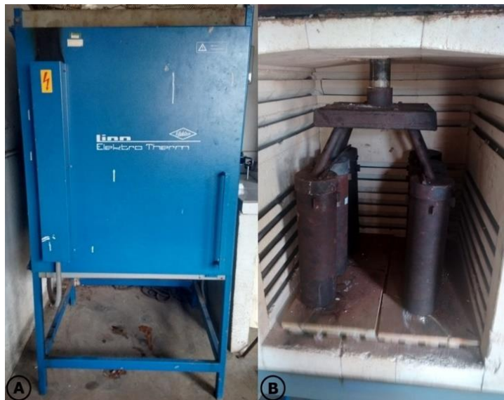
Figura 1 - Visão geral do forno mufla (A), visão da parte interna do forno e posicionamento dos cilindros metálicos (B).
