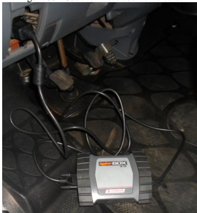
Figura 35 - Scanner instalado no veículo.
