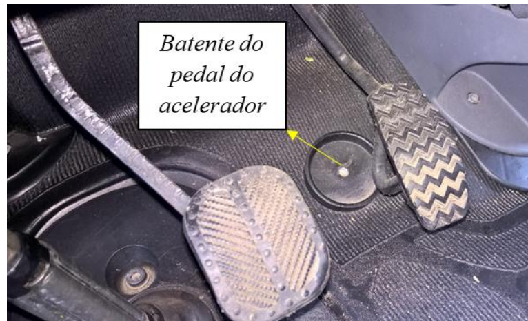
Figura 28 - Detalhe da posição onde foi fixado o suporte.
