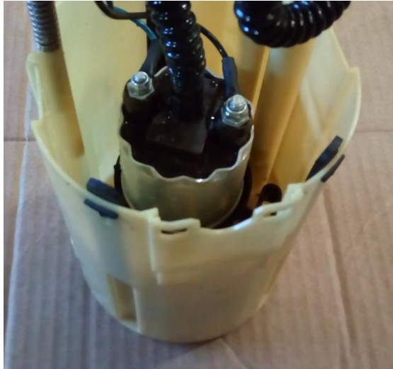
Figura 30 - Motobomba de combustível.
