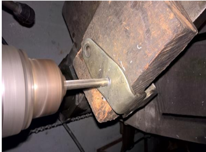
Figura 26 - Confecção do suporte de fixação do acelerador.
