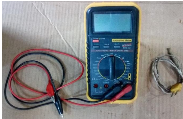
Figura 25 - Multímetro digital e termopar utilizado nos experimentos.
