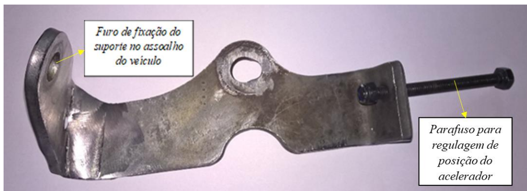
Figura 27 - Suporte do acelerador pronto
