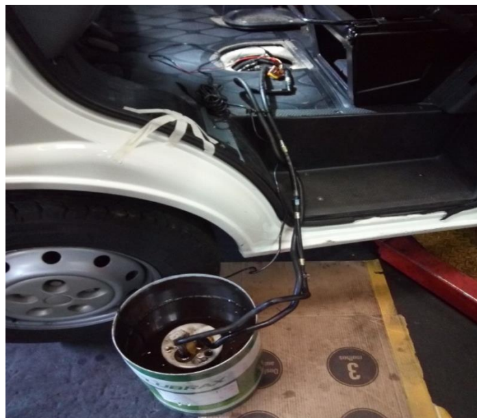
Figura 31 - Reservatório instalado no veículo.
