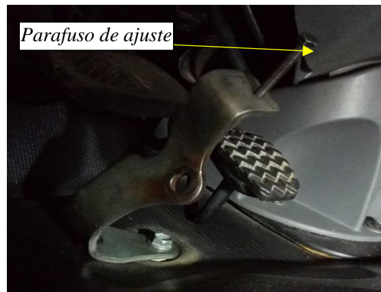
Figura 29 - Dispositivo de ajuste de rotação instalado.
