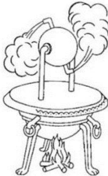
Figura 1 - Primeira Máquina Térmica de Héron.
