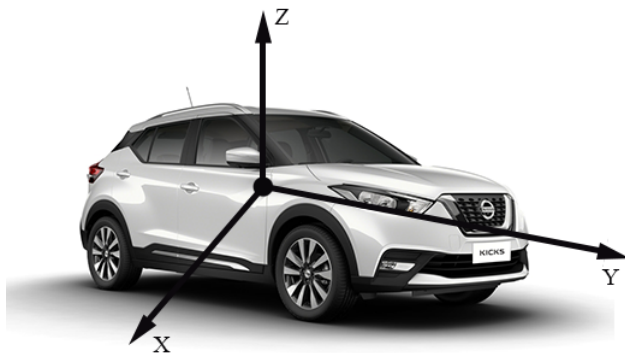
Figura 3.3 – Sistema de eixos do smartphone projetados no veículo.
