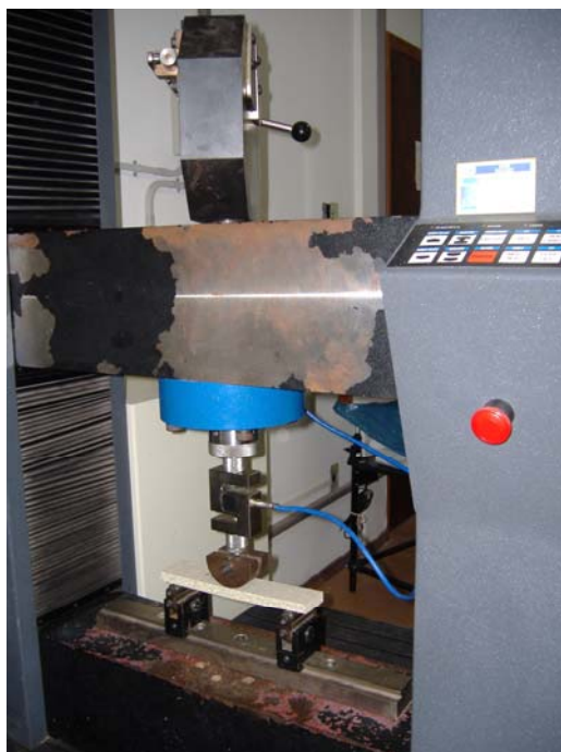
Figura 2 Ensaio de flexão estática do painel de bagaço de cana-de-açúcar
