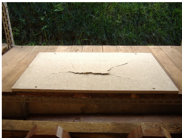
Figura 6 Rompimento pelo ensaio de impacto vertical observado na parte inferior do tampo da mesa
