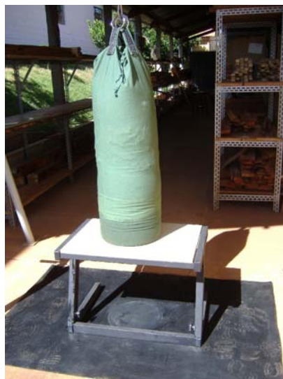
Figura 4 Ensaio de impacto vertical sobre a mesa, com queda da carga de impacto
