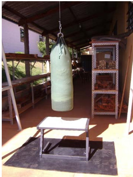
Figura 3 Ensaio de impacto vertical sobre a mesa, com altura de queda de 240 mm
