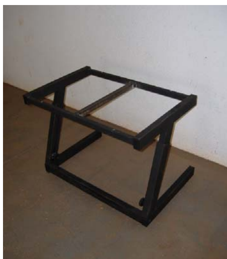
Figura 8 Estrutura da mesa depois da colocação da barra auxiliar
