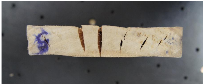
Figura 1: “Favos de mel” exemplo de colapso não recuperável.
