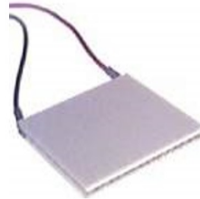
Figura 13 Célula de Peltier (Pastilha de Peltier ). Fonte: Moura (2010).
