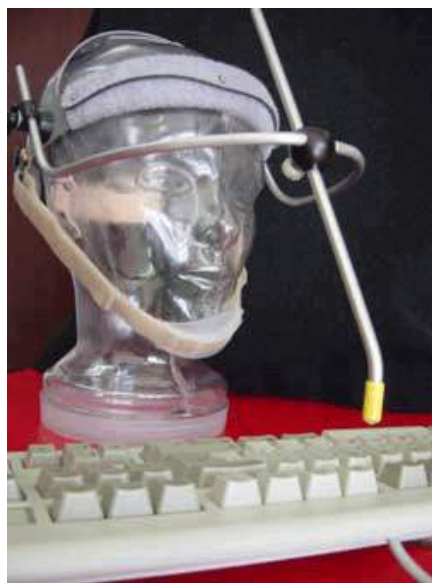
Figura 2 Exemplo de ponteiro de cabeça utilizado por pessoas com deficiência motora. Fonte: http://www.acessibilidade.net/web/ .
