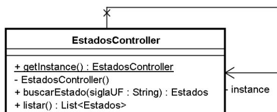
Figura 13 Diagrama de classe de uma implementação do padrão de projeto Singleton
