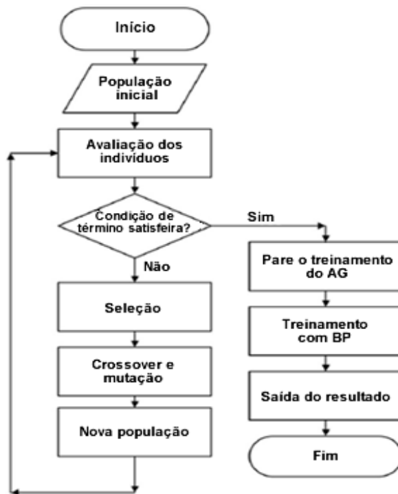
Figura 16 Framework combinando BP com AG Fonte: Adaptado de Irani e Nasimi (2011)
