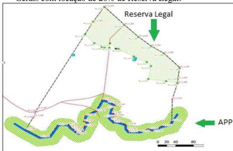
Figura 1 - Modelo de levantamento topográfico de propriedade em Minas Gerais com locação de 20% de Reserva Legal.
