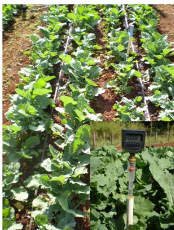
Figura 5 Leitura da tensão da água no solo com auxílio do tensiômetro, UFLA, Lavras-MG, 2008
