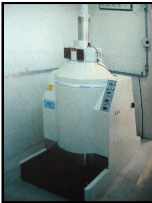
FIGURA 1 Irradiador 'Gammacell 220' do Centro de Energia Nuclear na Agricultura. Fonte de radiação gama emitida pelo radioisótopo ^{60}\text{Co} . CENA/USP, Piracicaba, 2005.
