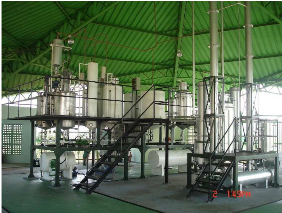
Figura 2: Unidade de produção de biodiesel pelo método de transesterificação
