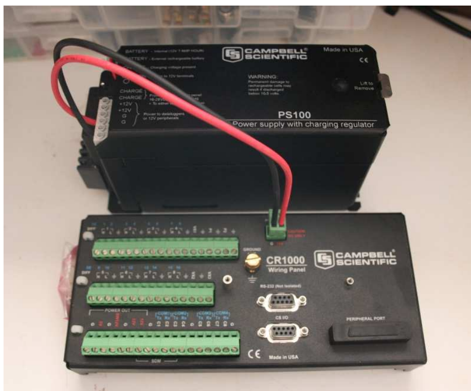
Figura 5: Datalogger CR1000 com fonte de alimentação PS100
