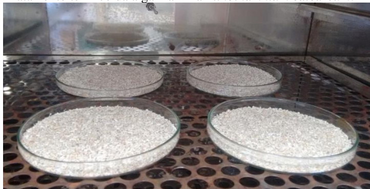
Figura 10 – Tratamento térmico da alga marinha Lithothamnium calcareum .
