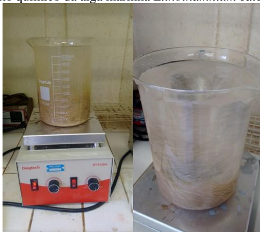
Figura 11 – Tratamento químico da alga marinha Lithothamnium calcareum .
