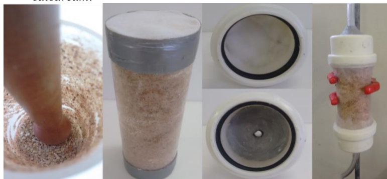
Figura 14 – Preparo e preenchimento da coluna com alga marinha Lithothamnium calcareum .
