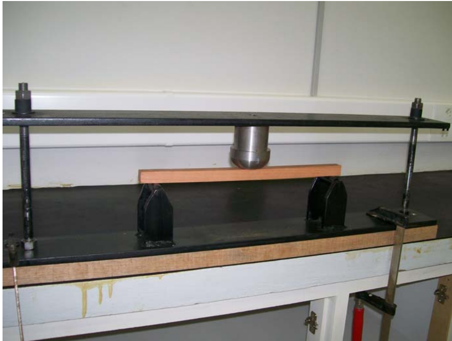
Figura 11 Configuração da montagem da ferramenta para aplicação de esforço de flexão estática com o corpo-de-prova
