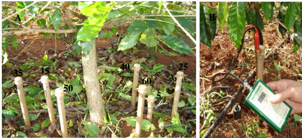
FIGURA 03 Sensores de tensão de água no solo ‘Watermark’, instalados junto à planta central, nas profundidades de: 5, 15, 25, 35, 40, 50 e 60 cm, para o controle da irrigação e o monitoramento do fluxo de água (A); Leitor para coleta de dados do equipamento (B). Lavras, MG, 2009.
