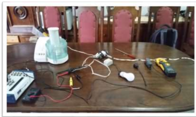
Figura 20: Multiprocessador de alimentos e Lâmpada de LED conectados no momento da aquisição dos dados.
