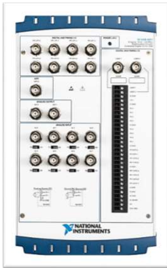
Figura 16: Placa de aquisição de NI USB-6251 fabricado por National Instruments
