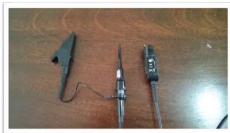
Figura 18: Ponteira para aquisição de dados de tensão.
