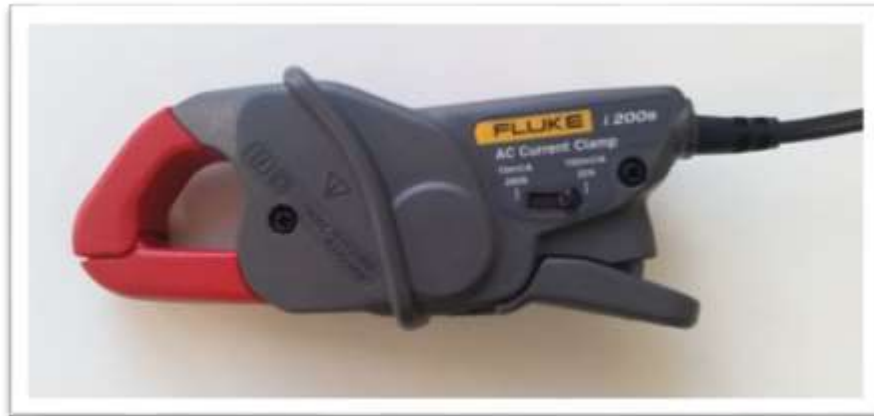
Figura 17: Ponteira de corrente FLUKE i200s
