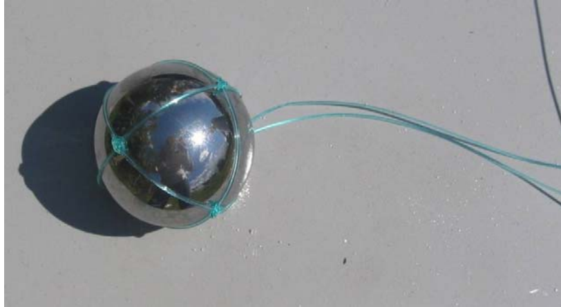
Figura 1 Esfera de tungstênio utilizada para calibração da ecossonda, diâmetro 33,2mm
