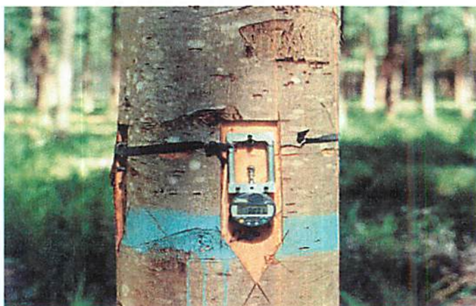
FIGURA 1 Detalhe do instrumento usado para medição da deformação residual longitudinal
