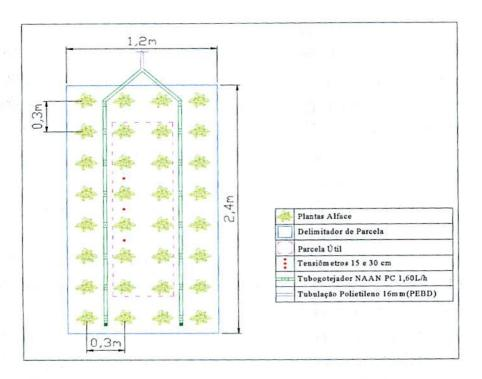
FIGURA 4. Esquema de uma parcela experimental com o sistema de irrigação implantado e os sensores de umidade. UFLA, Lavras, MG, 2005.
