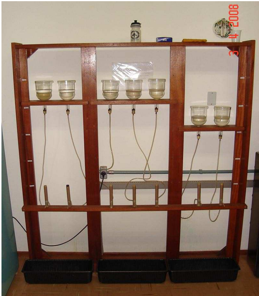
Figura 2 Funil de Placa Porosa. Laboratório de Solos-DCS/UFLA, Lavras (MG). 2010
