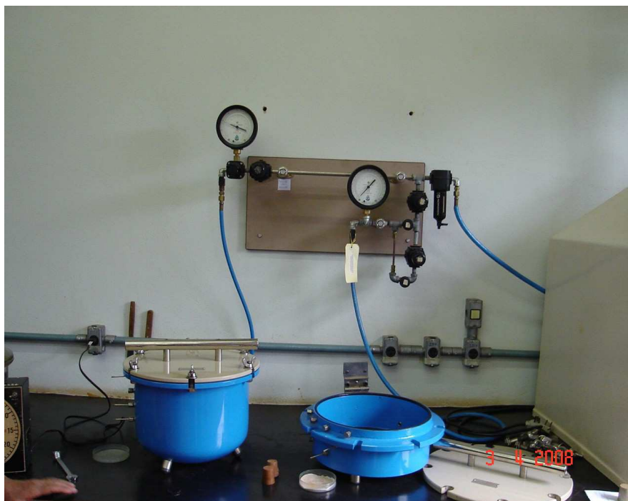
Figura 3 Câmara de Pressão de Richards. Laboratório de Solos-DSC/UFLA. Lavras (MG). 2010
