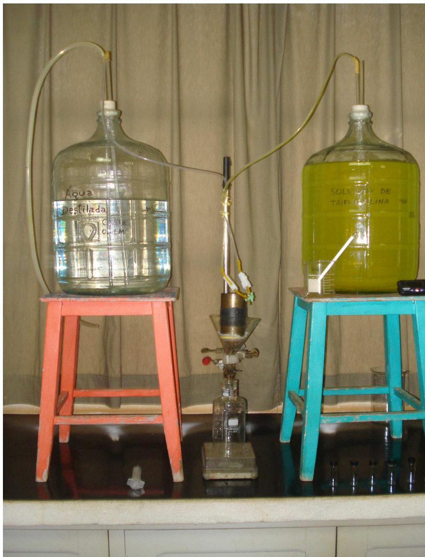
Figura 2 Aparato dos ensaios de deslocamento miscível. UFLA/DEG, Lavras-MG, 2010
