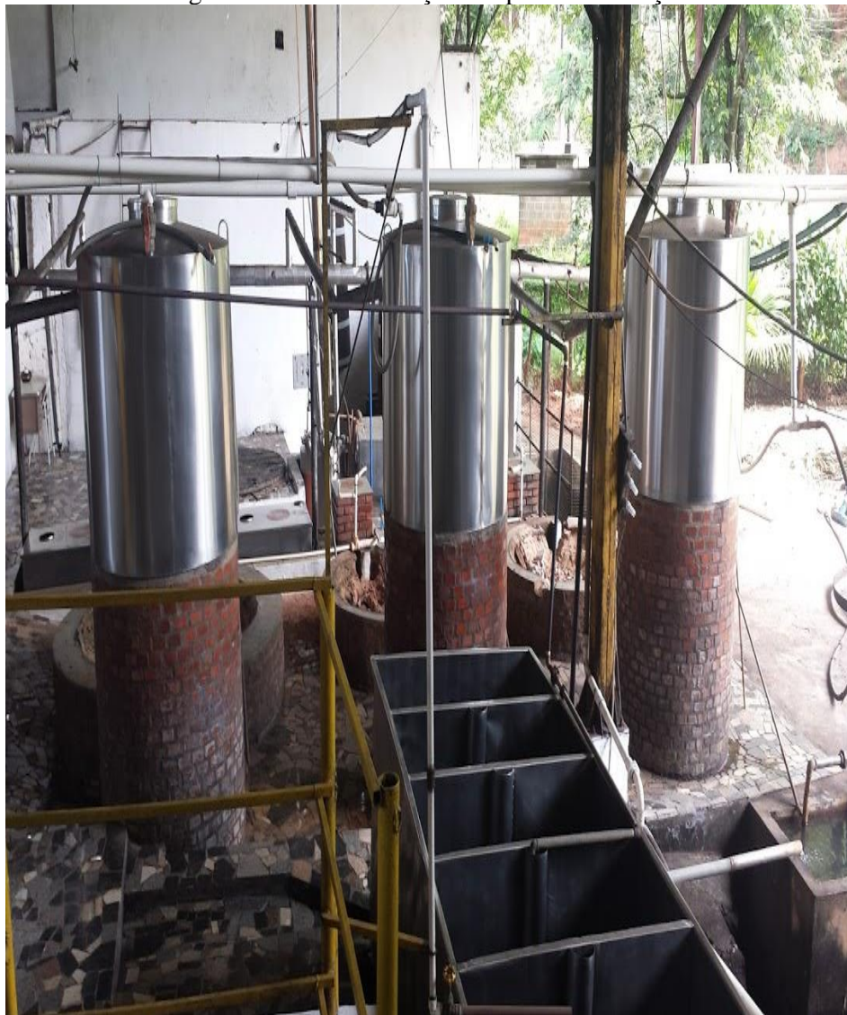
Figura 13 – Dornas de aço inox para fermentação.
