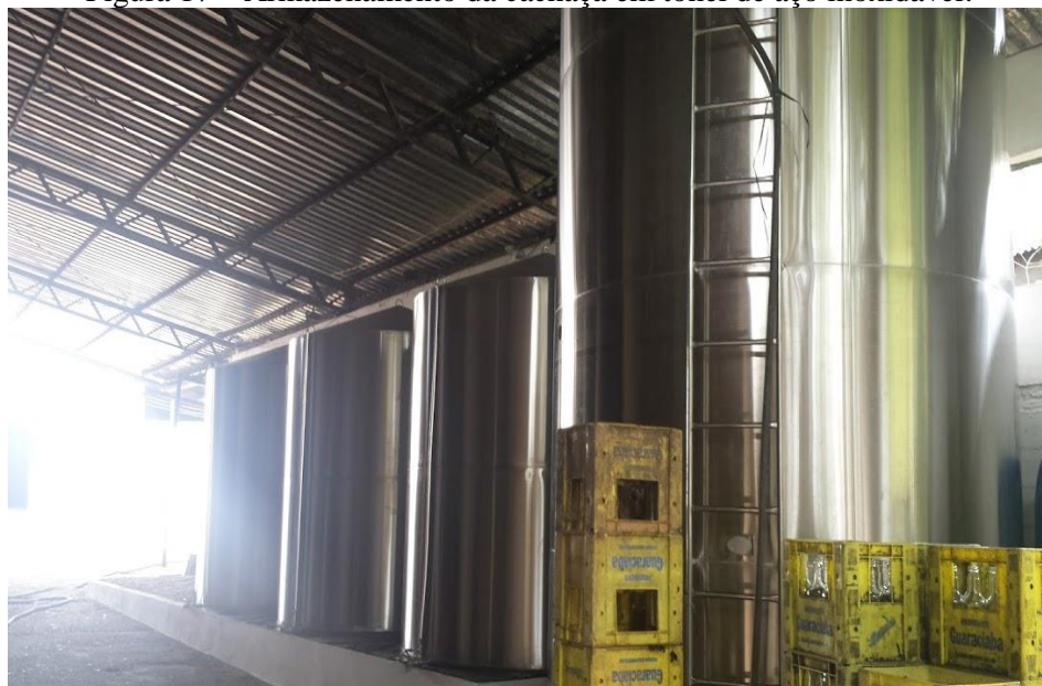
Figura 17 – Armazenamento da cachaça em tonel de aço inoxidável.
