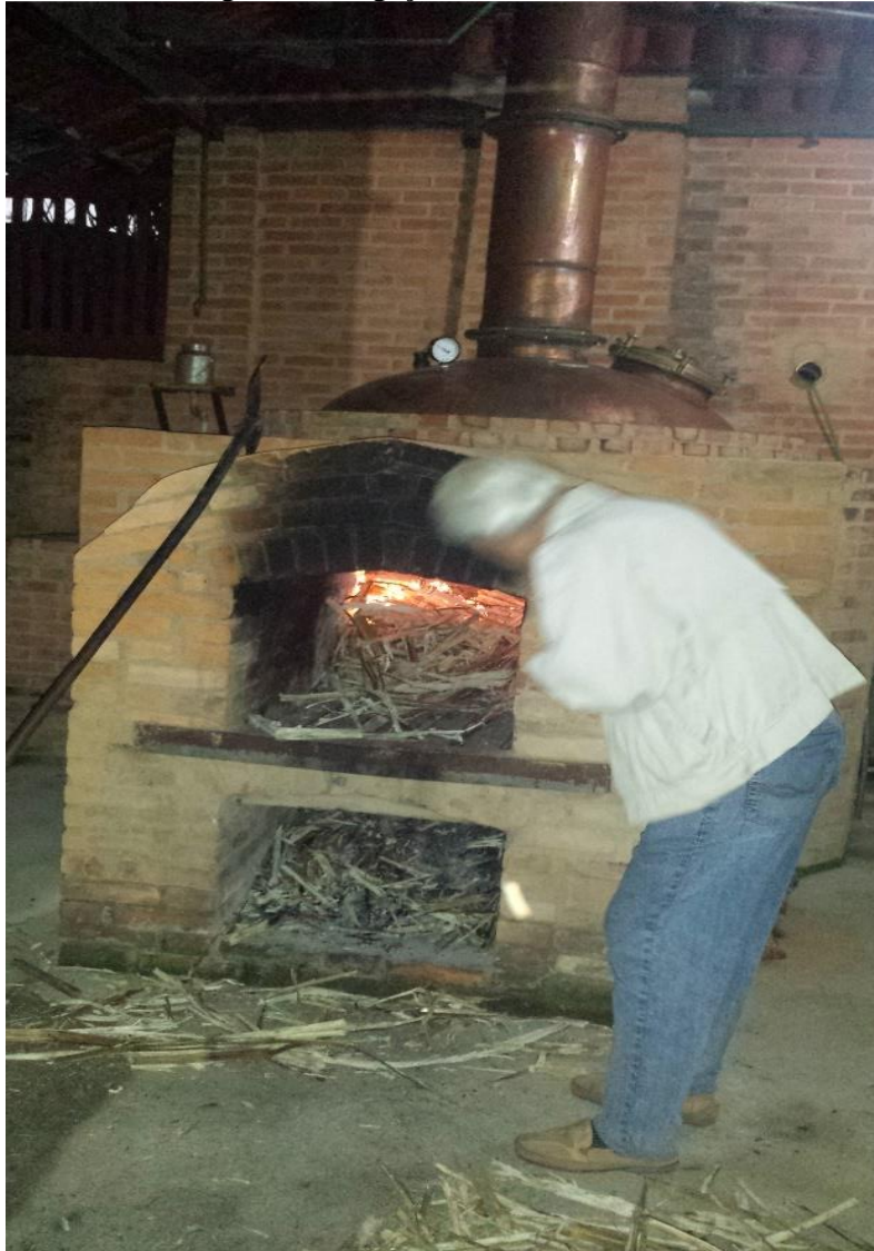
Figura 8 – Bagaço da cana na fornalha
