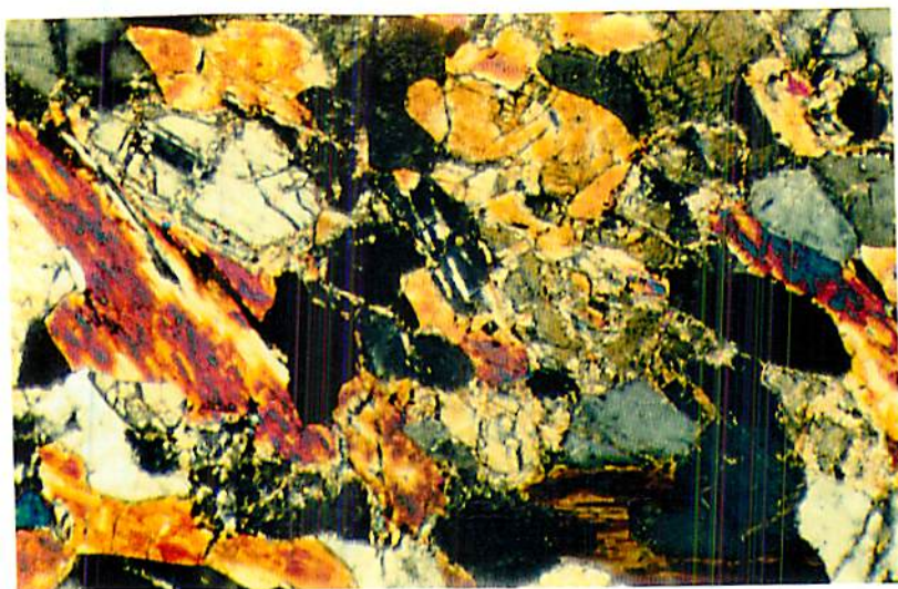
MICROFOTOGRAFIA 4.13 - PERFIL MHL-3 - AMOSTRA MHL-3R 1 - Fácies rocha alterada. Feições de alteração mineralógica (planos de clivagem e microfraturas) em cristais de plagioclásio, clinopiroxênio e anfíbólio. (Obj. 6.3x; Oc. 8x; nicóis cruzados).
