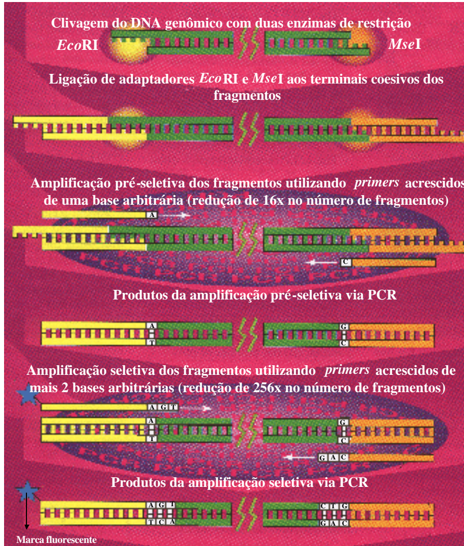
Figura 1. Representação esquemática da técnica de AFLP ( Amplified Fragment Length Polymorphism , Polimorfismo de Comprimento de Fragmentos Amplificados) (Fonte: Perkin Elmer, 1996). Embrapa Milho e Sorgo, Sete Lagoas, MG, 2003.
