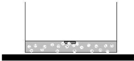
FIGURA 22 Biofilme de fécula de batata em estado líquido e um pedaço de biofilme de fécula de batata em gel posicionado no centro da placa sobre a camada líquida. Abaixo da amostra de biofilme foi colocado um pedaço de papel preto.
