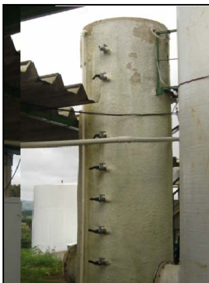
FIGURA 12. Reator anaeróbio híbrido do sistema piloto de tratamento da água residuária do café localizado no NECAF/UFLA.
