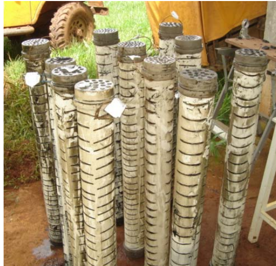
FIGURA 13. Minifiltros de PVC, contendo argila expandida e seixo rolado, que foram colocados dentro do Reator Anaeróbio Híbrido do sistema piloto de tratamento da água residuária do café (ARC), localizado no NECAF/UFLA.
