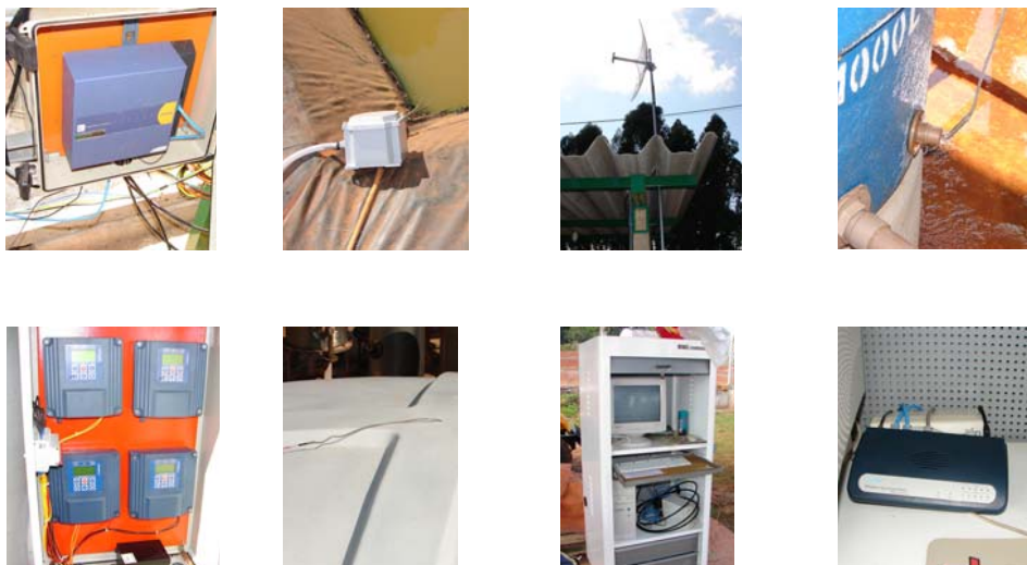
FIGURA 17. Equipamentos utilizados para a medição de temperatura das unidades do sistema piloto de tratamento da água residuária do café localizado no NECAF/UFLA.
