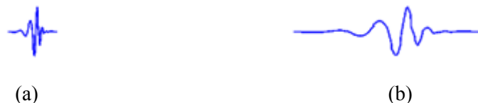
Gráfico 2 Ação do fator de escala sobre uma função wavelets. Baixa escala (a) e alta escala (b)
