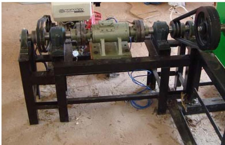
Figura 4 Base construída para o transdutor de torque
