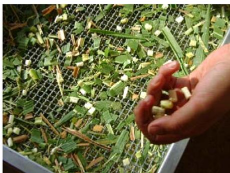
Figura 13 Peneiramento e separação das partículas para determinação do tamanho médio
