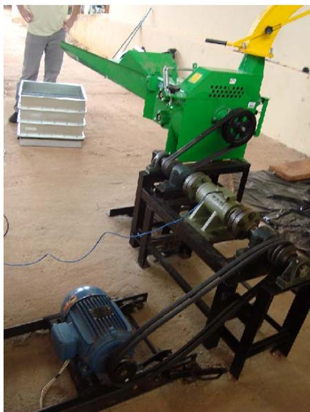
Figura 6 Torquímetro acoplado a picadora
