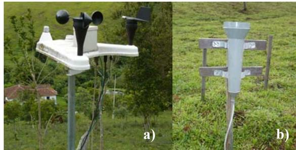
FIGURA 9 Equipamentos utilizados para monitorar a precipitação; a) estação meteorológica e b) pluviômetro.
