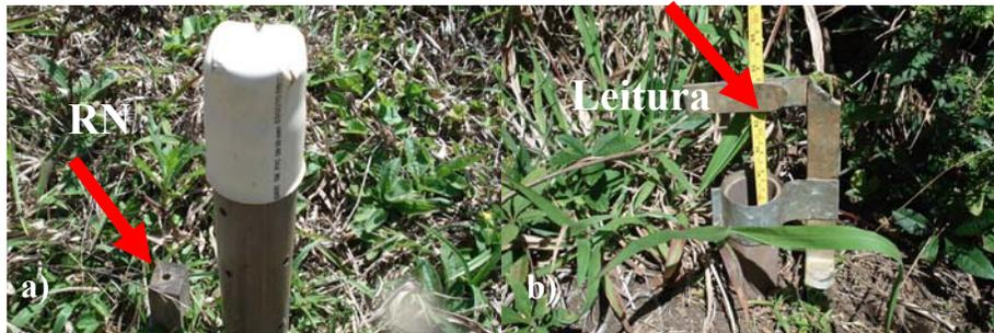
FIGURA 10 a) Poços de observação do aquífero não confinado e b) leitura do nível do aquífero não confinado.
