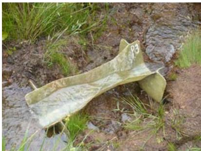
FIGURA 8 Medidor de vazão WSC Flume usado no monitoramento.
