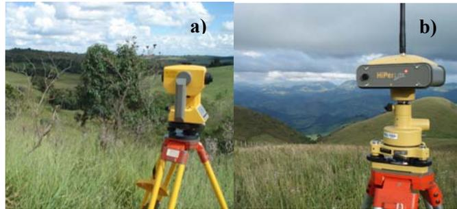
FIGURA 6 Equipamentos utilizados nos levantamentos topográficos; a) estação total marca Trimble modelo 305 e b) receptor GPS marca Topcon modelo Hiper® Lite.
