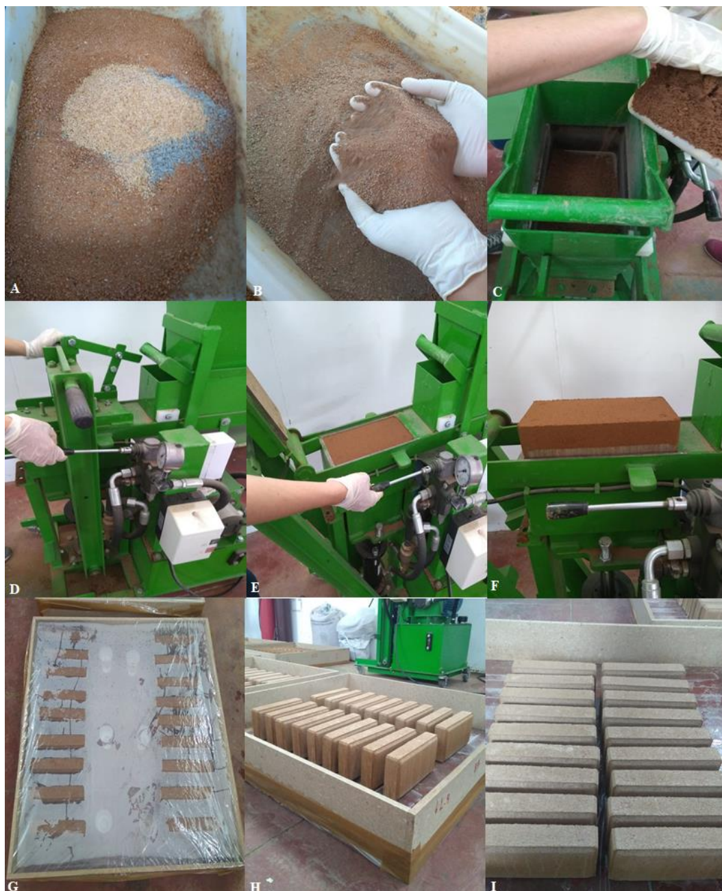
Figura 1 – Processo de produção dos tijolos solo-cimento
