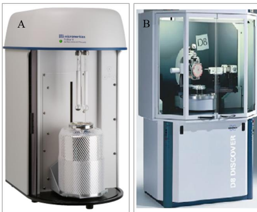
Figura 1. (A) Equipamento Micromeritics TriStar II Plus . (B) e Difractômetro de Raios-X (XRD) HotBird Bruker-AXS, modelo D8 Discover .
