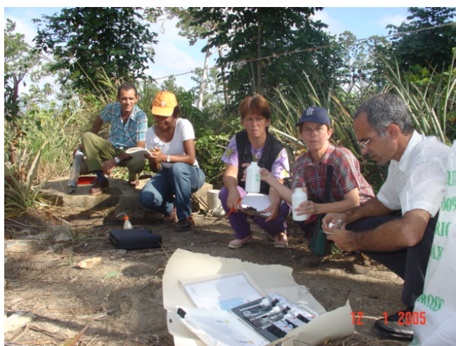
FIGURA 6B Parte da equipe de trabalho do projeto, do INRH e do IGA (Cuba). Medição da concentração semi-quantitativa de nitrito e nitrato em água com o kit portátil da Aquamerck .
