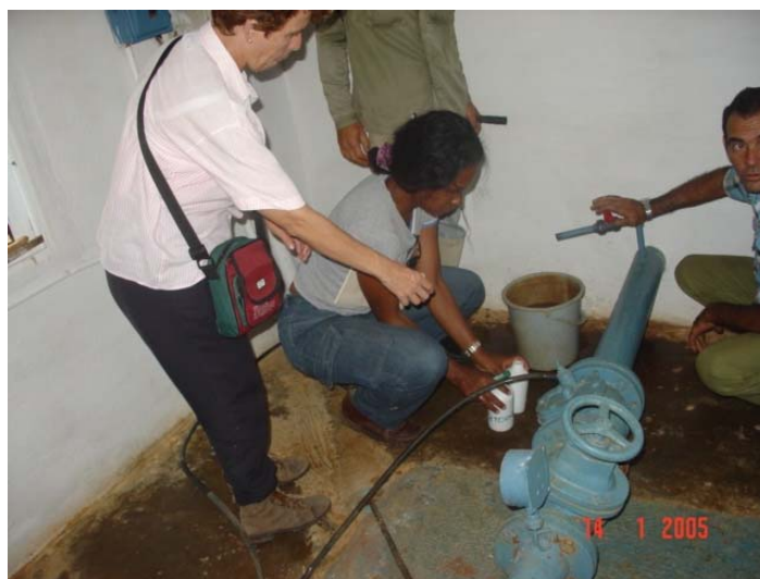
FIGURA 2 Coleta de amostras de água na estação V-28 que abastece ao povoado da mina Delita e o município Victoria.
