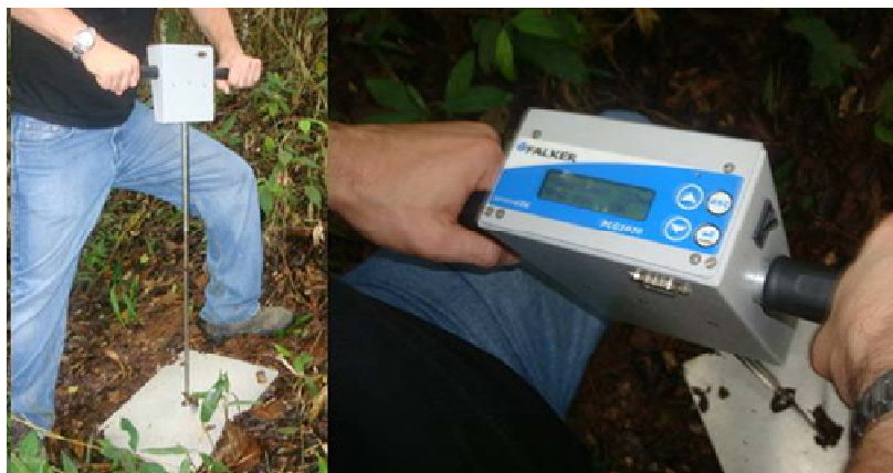
FIGURA 13 Ensaio de resistência do solo à penetração (RP), realizado com o penetroLOG – medidor eletrônico de compactação do solo.
