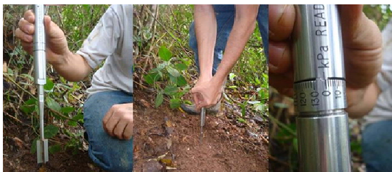
FIGURA 12 Resistência ao cisalhamento do solo pelo ensaio de palheta.
