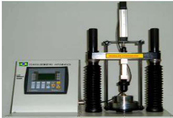
FIGURA 8 Consolidômetro automático com IHM Modelo CNTA-IHM/BR-001/07. Fonte: Silva & Masquetto (2009)
