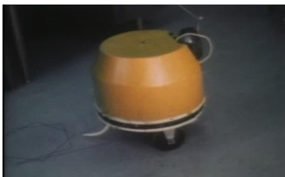
Figura 2- Robô criado por Papert representação física da tartaruga. Fonte: Walter, (2010)
