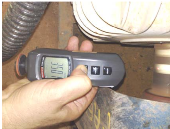
Figura 30 Utilização do tacômetro para leitura da rotação do eixo do conjunto motobomba
