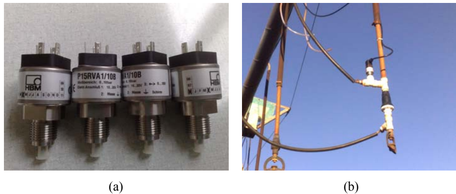
Figura 33 Sensores de pressão HBM, modelo P15RVA1/10B (a) e posição instalada dos sensores de pressão HBM no mesmo ponto de tomada de pressão dos data loggers (b)
