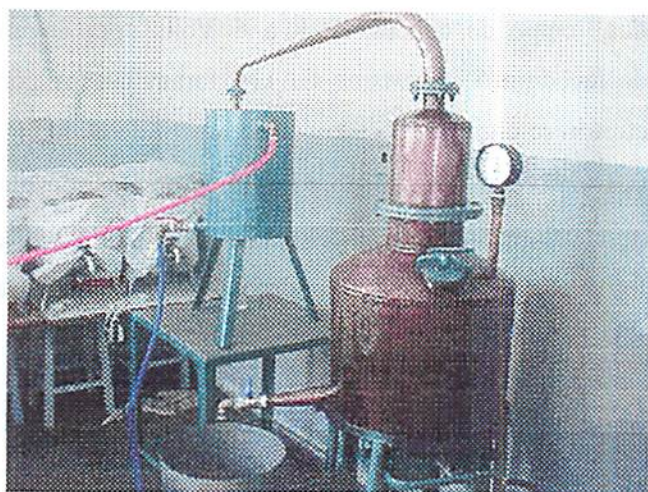
FIGURA 3 Alambique utilizado no experimento
