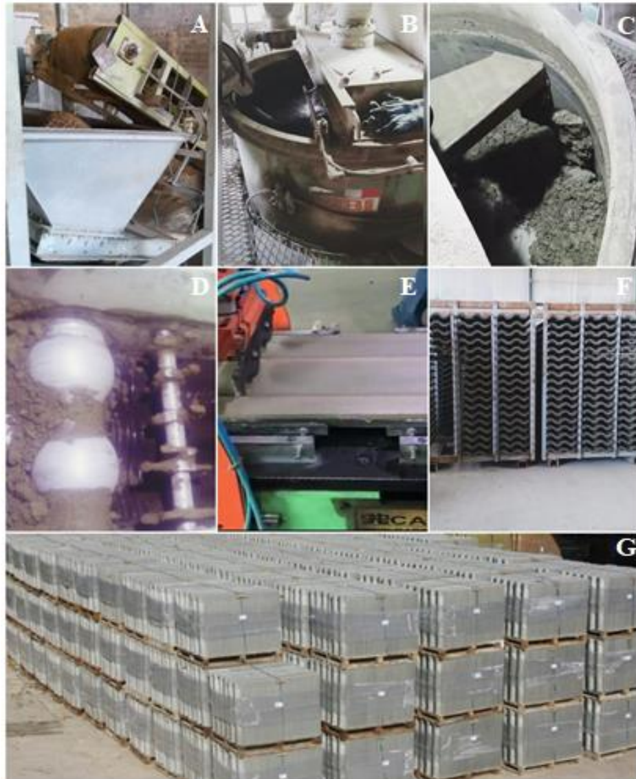
Figura 2 - Processo de produção das telhas de concreto.
