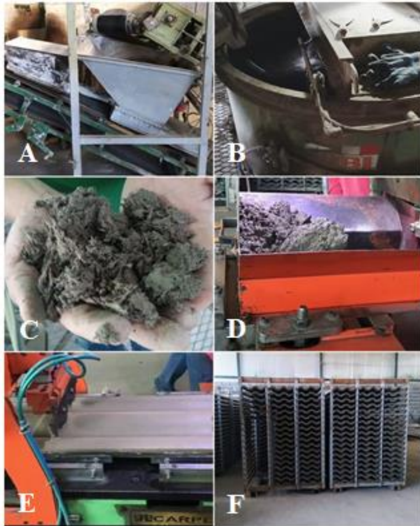
Figura 1 - Processo de produção das telhas de concreto.
