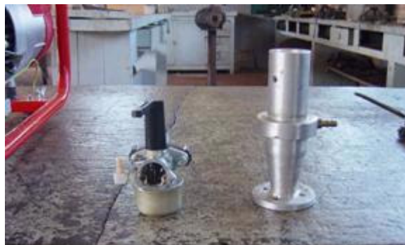
FIGURA 6 Carburador original e carburado dimensionado
