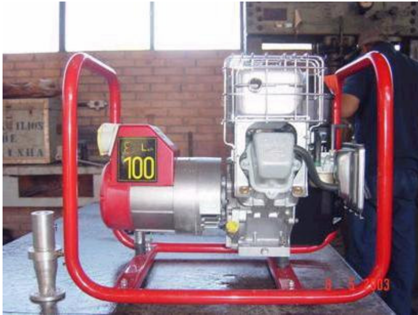
FIGURA 5 Conjunto motogerador e carburador dimensionado
