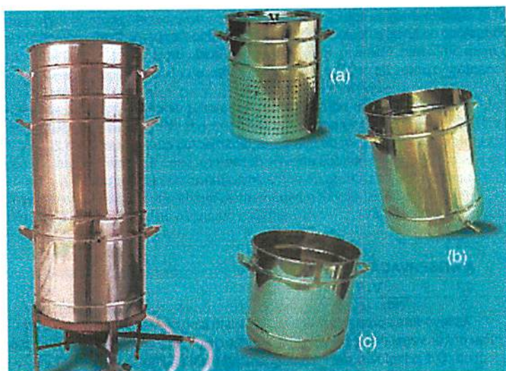
FIGURA 5 Equipamento utilizado para extração do suco por método caseiro. a) recipiente onde se colocam as bagas de uva; b) passagem do vapor d'água e recolhimento do suco; c) água em ebulição (Rizzon, Manfroi e Meneguzzo, 1998).
