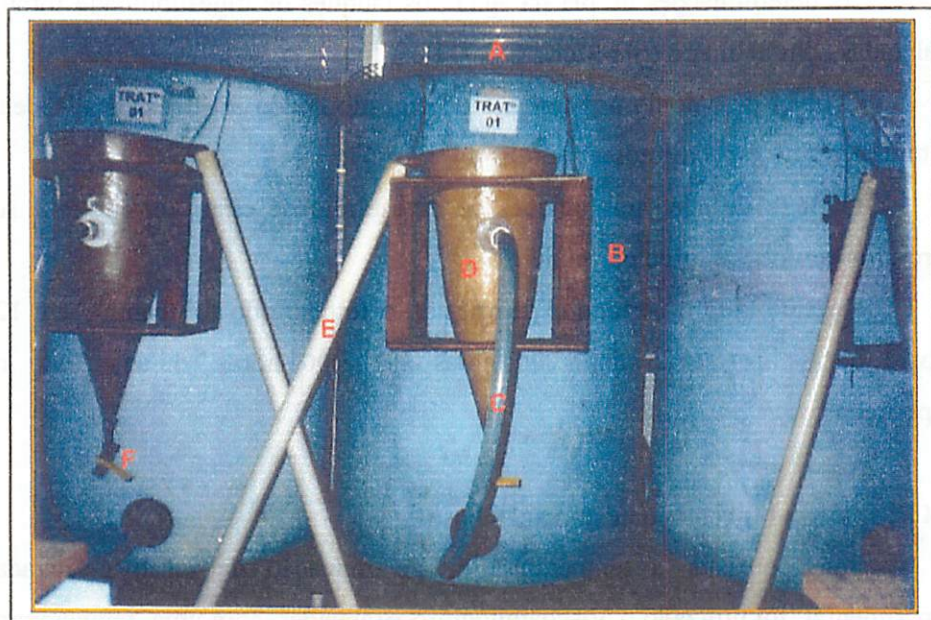
FIGURA 02. Câmara de digestibilidade: A – entrada de água, B – tanque de digestibilidade, C – mangueira de fluxo de água, D – coletor de fezes, E – saída de água e F – local de coleta de fezes.
