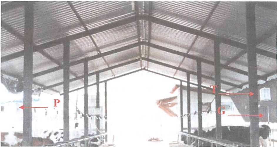
FIGURA 8. Disposição dos equipamentos de coleta de dados do ambiente: psicrômetro (P), termohigrógrafo (T) e termômetro de globo negro (G).
