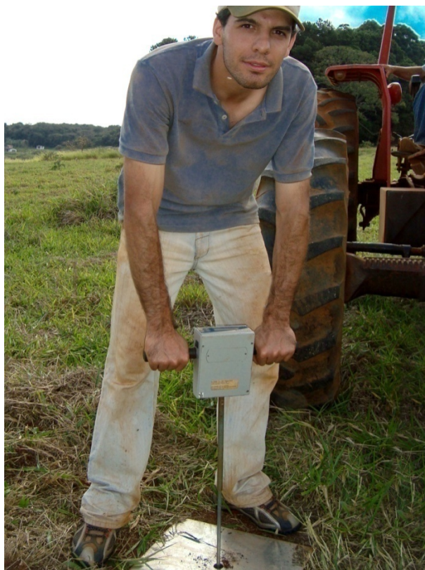
FIGURA 6 Coleta de dados através do penetrômetro eletrônico para avaliação da resistência do solo à penetração.
