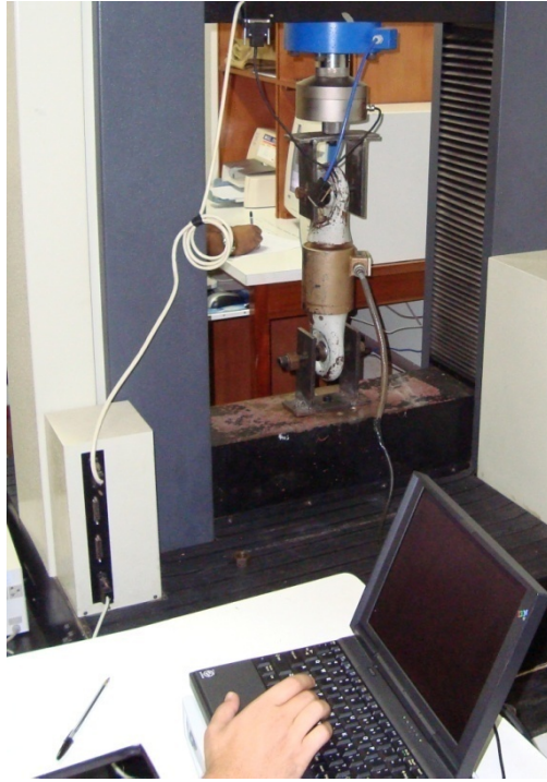
FIGURA 3 Calibração da célula de carga através da máquina de ensaio universal.
