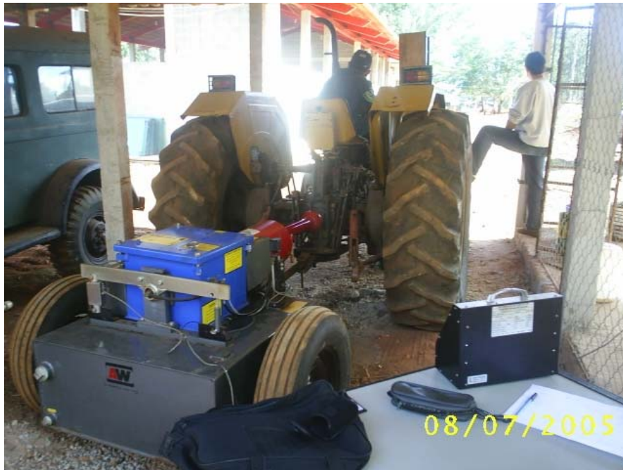
FIGURA 3 Dinamômetro acoplado a TDP do trator
