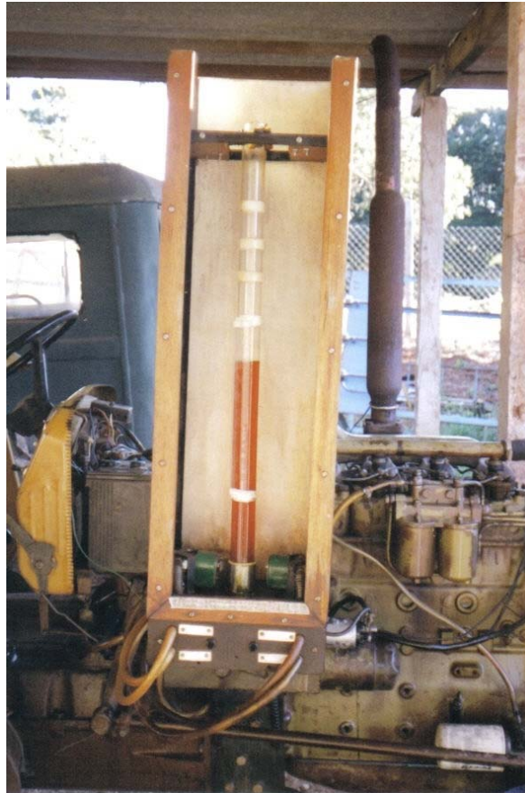
FIGURA 2 Medidor volumétrico de combustível
