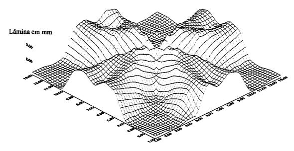
FIGURA 13 - Perfil de distribuição em superficie para o bocal com orificio Quadrado CUC = 69%
