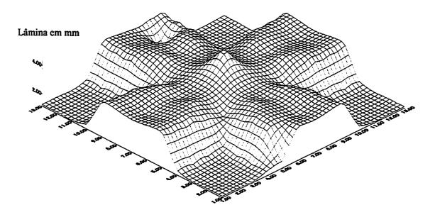
FIGURA 18 - Perfil de distribuição em superficie para o bocal com orificio Duplo Círculo CUC = 62%
