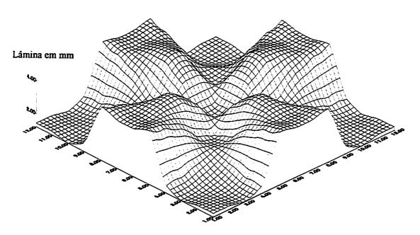
FIGURA 14 - Perfil de distribuição em superficie para o bocal com orificio Triângulo CUC = 65 %
