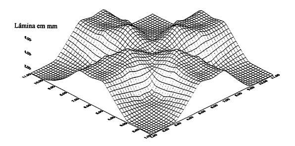
FIGURA 20 - Perfil de distribuição em superficie para o bocal com orificio ½ círculo CUC = 55 %
