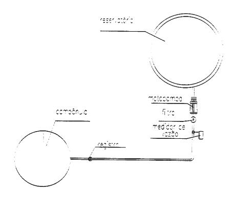
FIGURA 6 - Montagem do sistema.
