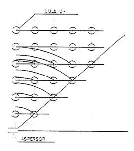
FIGURA 8 - Esquema usado para a simulação da malha de coletores (Adaptado da norma ISO 7749 - 2)
