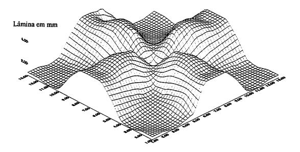
FIGURA 19 - Perfil de distribuição em superficie para o bocal com orificio ¼ do círculo CUC = 55 %
