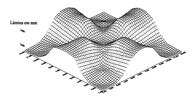
FIGURA 16 - Perfil de distribuição em superficie para o bocal com orificio Elíptico CUC = 67 %
