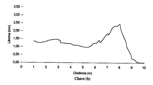
FIGURA 12 - Perfil de distribuição de precipitação desenvolvidos pelos bocais produzidos no laboratório.
