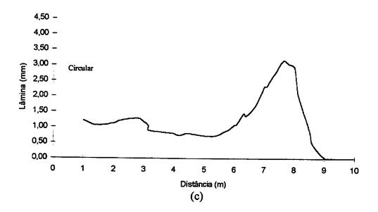
FIGURA 10 - Perfis de distribuição de precipitação desenvolvidos pelo bocal Quadrangular (a), Triangular (b) e Circular (c) produzidos pelo fabricante.
