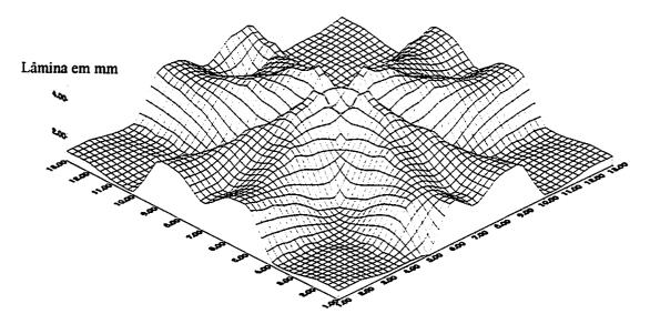
FIGURA 15 - Perfil de distribuição em superficie para o bocal com orificio Círculo CUC = 50 %
