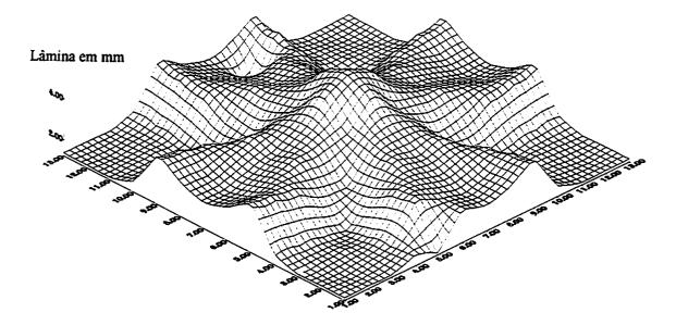
FIGURA 17 - Perfil de distribuição em superficie para o bocal com orificio Chave CUC = 65 %
