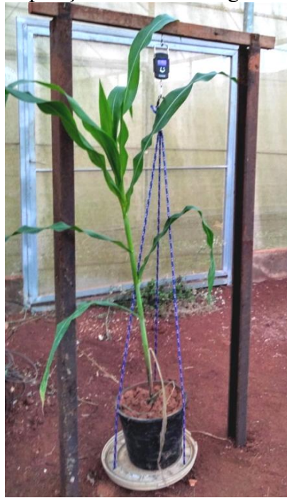
Figura 7 - Pesagem dos vasos e reposição da lâmina d'água consumida por evapotranspiração.
