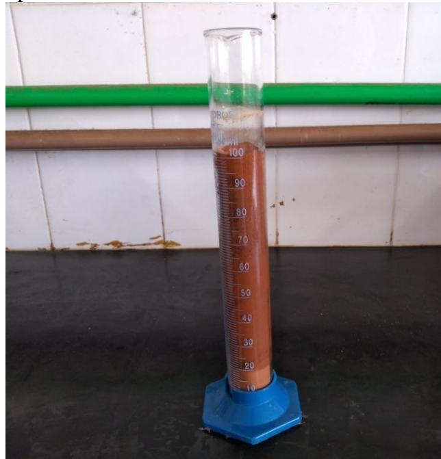
Figura 5 - Visualização da proveta preenchida com solo na qual foi adicionada água e mantida em repouso por 5 horas.
