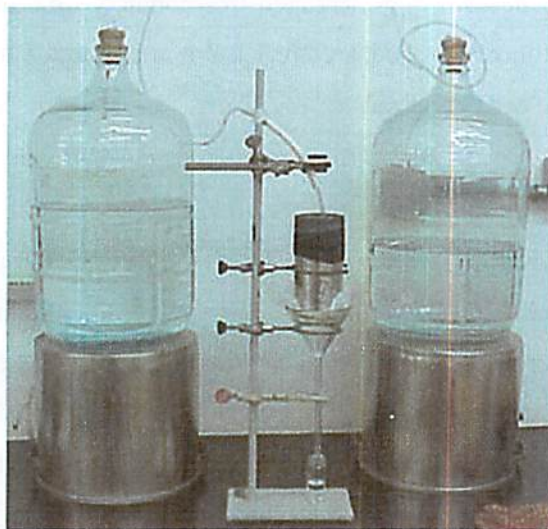
FIGURA 3.1 Sistema de lixiviação das colunas, feito com frascos de Mariotes, um contendo a solução de \text{CaCl}_2 0,01M e outro a solução de atrazina 10 \text{ mg L}^{-1} .
