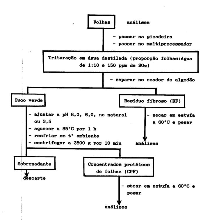
FIGURA 3 - Fluxograma para obtenção do concentrado protéico de folha de cana-de-acúcar.
