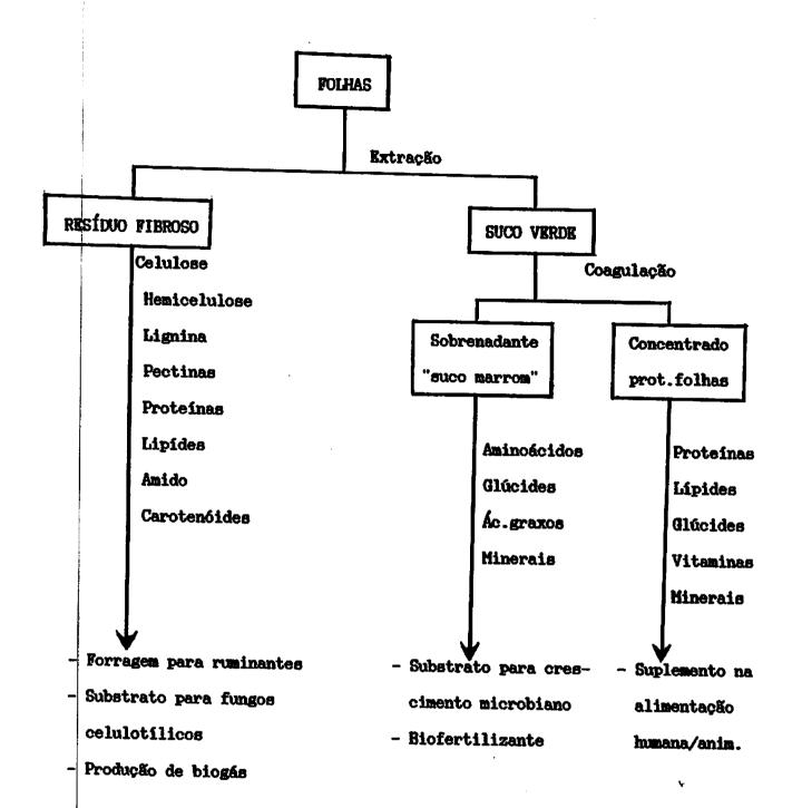
FIGURA 2 -Esquema de obtenção do CPF indicando os subprodutos de extração, a composição de mutrientes de cada fração e suas aplicações (ESPÍN-DOLA, 1987).
