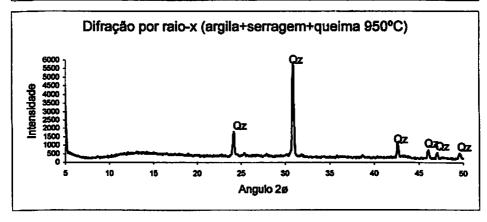
FIGURA 2.4 – Teste de difração por raios-X, em três amostras de argila e seus picos difratométricos da Caulinita (Kt) e do Quartzo (Qz).
