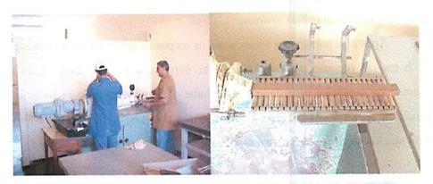
FIGURA 2.1- Extrusão dos corpos de prova.
