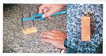
Figura 2.2 - Marcação e numeração dos corpos de prova.
