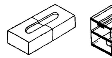
FIGURA 3.2 - Preparo do corpo de prova do teste de compressão
