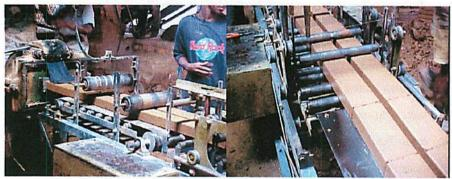
FIGURA 3.1 - Extrusão e corte do tijolo maciço cerâmico
