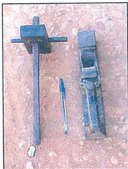
FIGURA 7. Ferramentas utilizadas em marcenaria, fabricadas com madeira nativa da região do município de Ingaí, MG. Graminho e plaina de jacarandá roxo (A) e plaina de óleo bálsamo(B).
